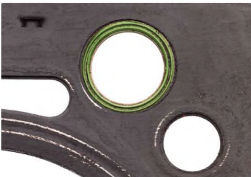
Zdj. 3: zanieczyszczenia w wyniku stosowania masy uszczelniającej na zewnętrznej krawędzi zielonego elementu z elastomeru oraz na powierzchni uszczelki
