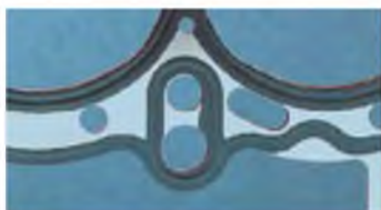
Zdj. 2: obszar kanału olejowego z metalicznym rowkowaniem pod czarną powłoką
